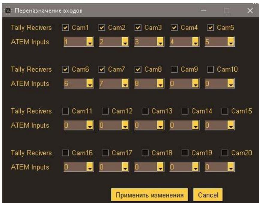
Активируйте номера камер, на которые у вас настроены приемники и выберите номера входов микшера для соответствия номерам кнопок микшера. Отключайте, не используемые системой талли, номера камер. По окончании настройки нажмите кнопку «Применить изменения».
