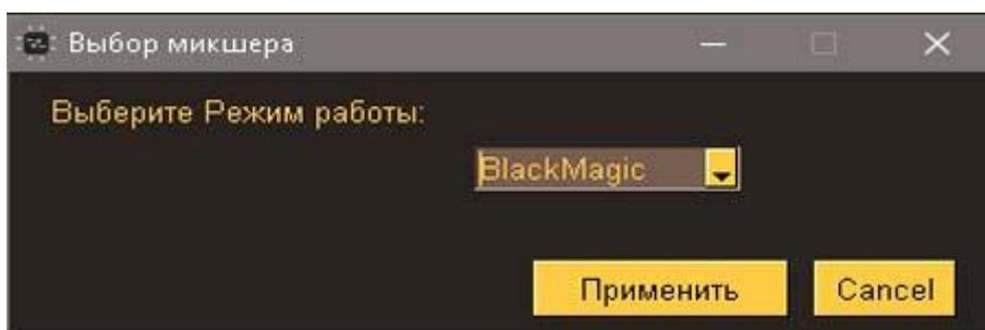
то при помощи этой кнопки вы можете выбрать микшер, с которым собираетесь работать (или дополнительные режимы как «Сетевой повторитель» или «Радиоповторитель» они нужны, если вы используете второй передатчик для расширения площади покрытия).
