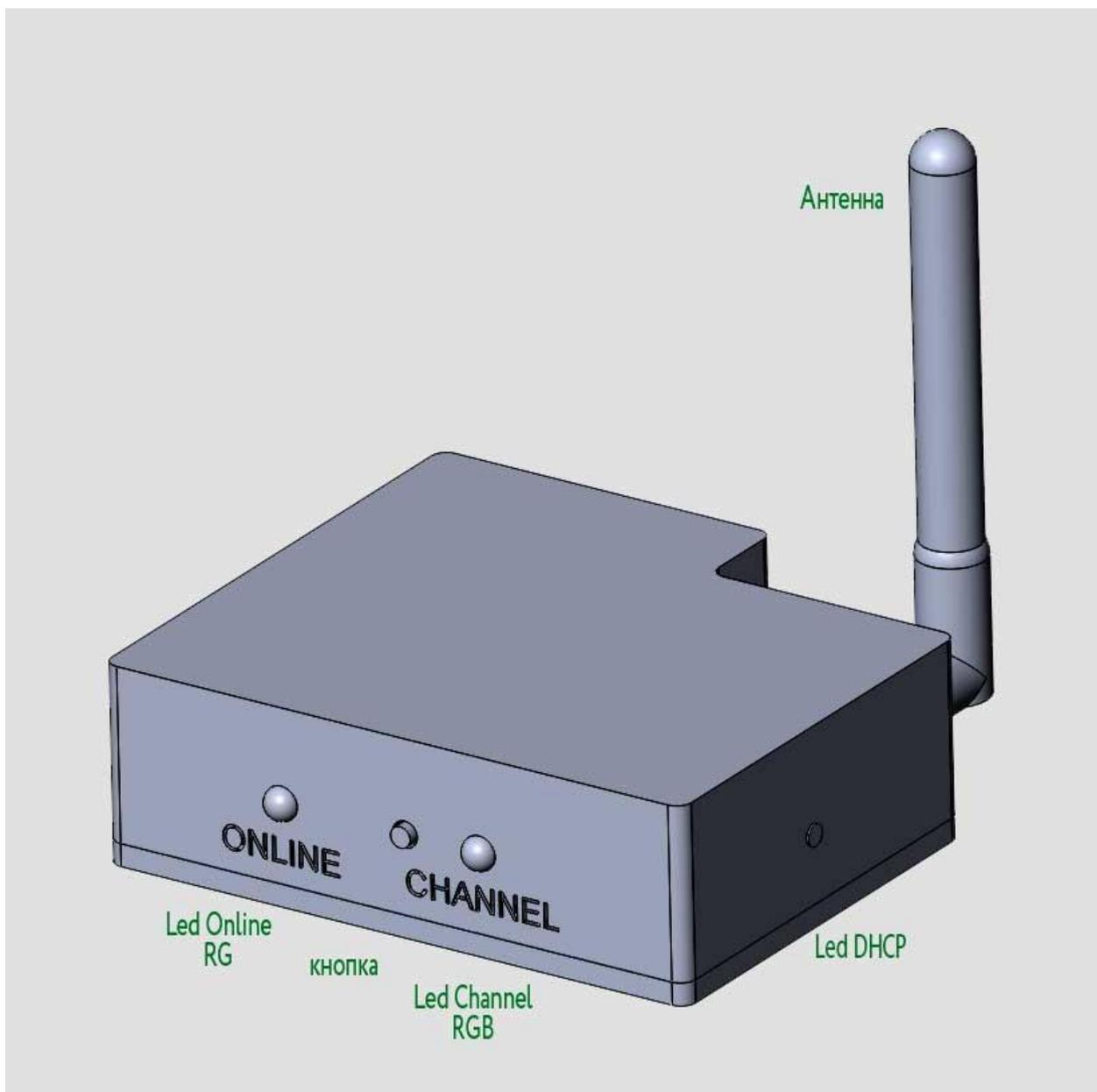
«Кнопка» (короткое нажатие) активирует режим «ТЕСТ». В этом режиме передатчик отключается от микшера и самостоятельно перебирает все камеры. Этот режим полезен для проверки сигнала и настройки приемников. Выход из режима «ТЕСТ» - повторное короткое нажатие «кнопки»
