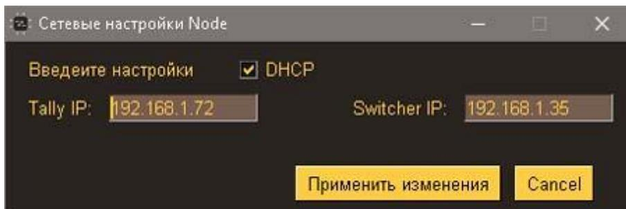
Если оставить галочку «DHCP», то введенный адрес в поле Tally IP сохранится в памяти передатчика, но не будет использоваться, передатчик будет получать адрес от DHCP сервера. Для использования, введенного адреса и работы в сети со статическими адресами, снимите галочку «DHCP».
